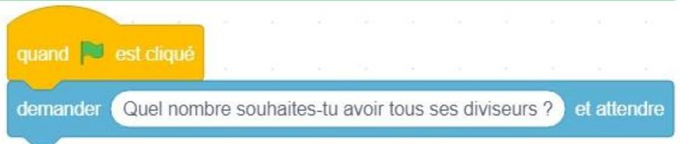
**Indication** : Il va falloir créer une variable **test** qui commencera à 1 et qui à chaque test augmentera de 1. On utilisera également l'outil de répétition.
